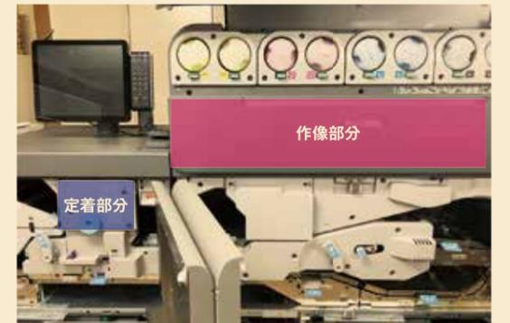
また、C9200の内部は「作像装置」と「定着装置」が離れていて、空間が広くとられているので、紙詰まりが起きた場合でも対応作業がしやすく簡単に印刷へ復帰することが出来ます。
